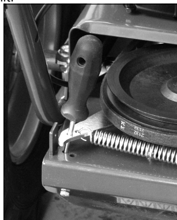
FIG.56 Rola baladoare blocați-o în poziția depărtată cu o șurubelniță Phillips
