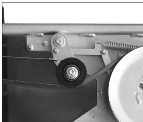
FIG. 66 Rola întinzătoare în poziția cosire activată (ON)
