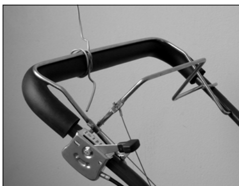
FIG. 67 Exemplu de blocare a pârghiei de comandă în poziția cosire activată (ON)
