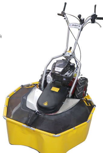
Fig.20 - Protecția exterioară montată pe utilaj (FD-2H + RZS-70K)
