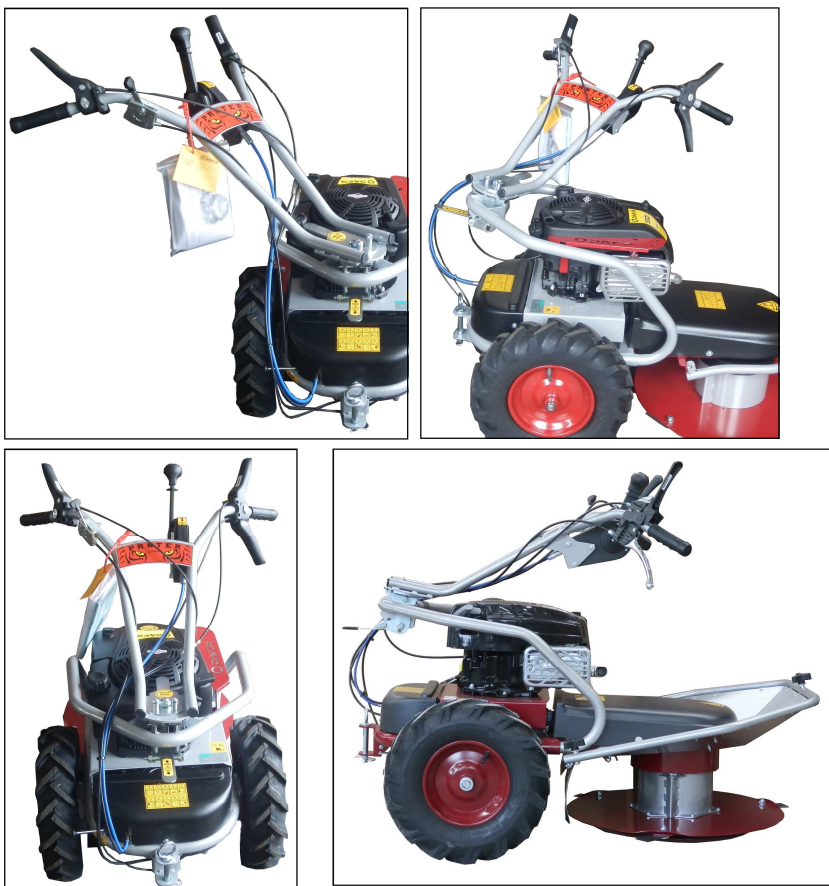
Fig. 10 Poziția cablurilor în timpul rotirii ghidonului sau în poziția de depozitare
