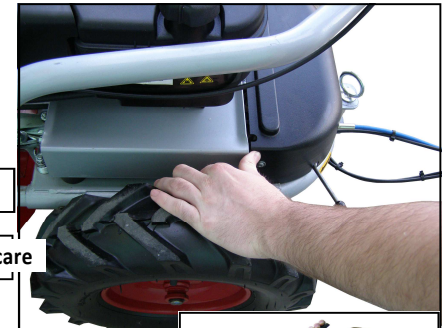
Fig. 36 Întărirea mecanismului de întindere
